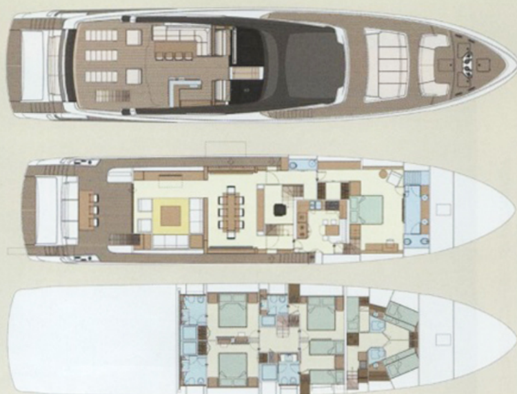
Drei Decks: Sundeck mit Flybridge, Zwischendeck mit Ruderhaus über den Gästen, Unterdeck für zwei VIPs und eine vierköpfige Crew plus Kapitän.
